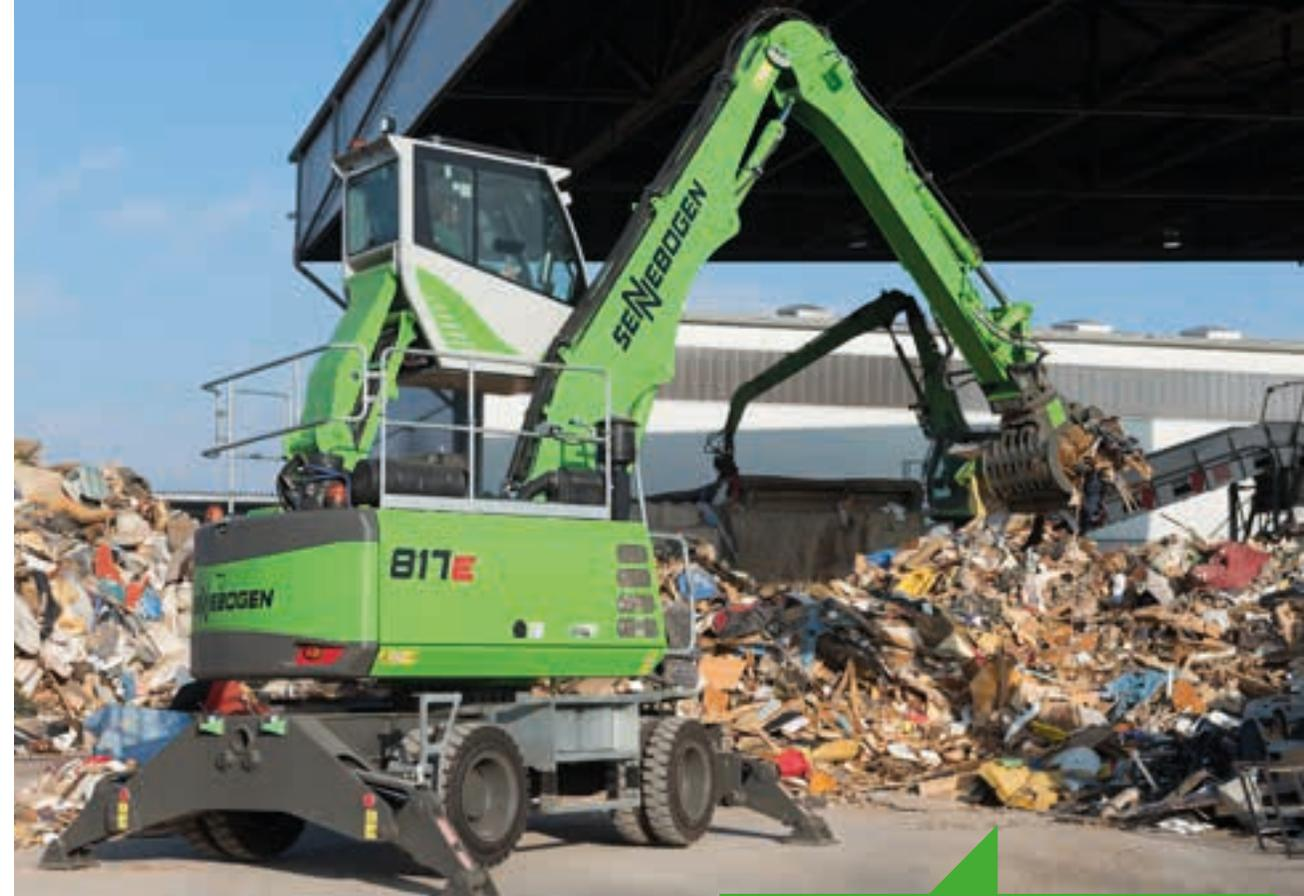
Mit einem Einsatzgewicht von rund 17 t und bis zu 9 m Reichweite reiht sich die neue Maschinenklasse des 817E bewusst unterhalb der bisherigen SENNEBOGEN Umschlagbagger ein. Lediglich 2,54 m misst die Maschine in der Breite.
