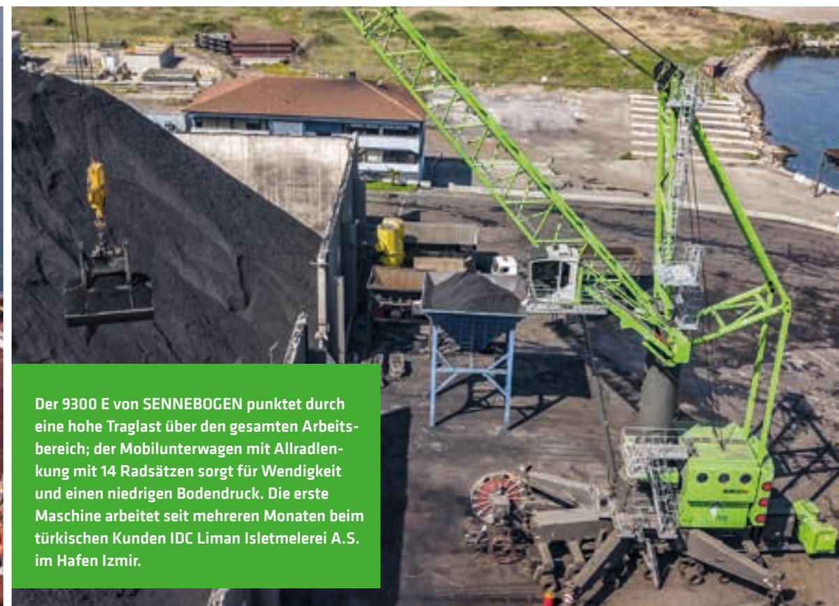
Der 9300 E von SENNEBOGEN punktet durch eine hohe Traglast über den gesamten Arbeitsbereich; der Mobilunterwagen mit Allradlenkung mit 14 Radsätzen sorgt für Wendigkeit und einen niedrigen Bodendruck. Die erste Maschine arbeitet seit mehreren Monaten beim türkischen Kunden IDC Liman Isletmelerei A.S. im Hafen Izmir.
